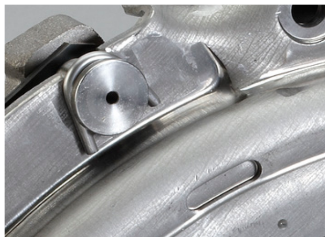
Рисунок 2: Проволочные закладные установлены между корпусом сцепления и направляющими ограничителями
